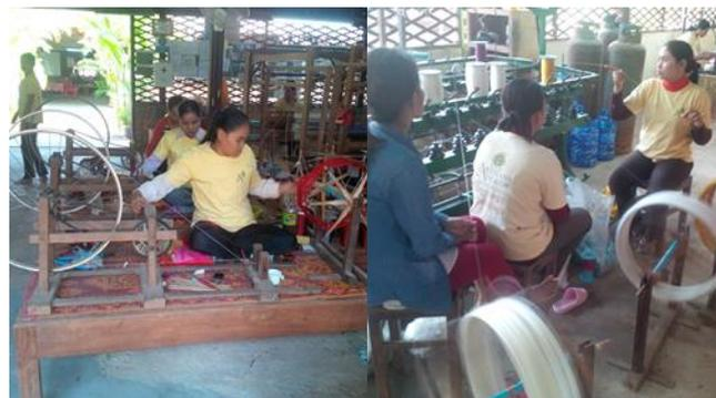
Cadrage manuel (rouet) et semi-mécanique
